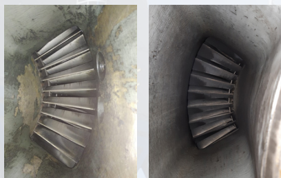
а) Лопатки двигателя после наработки 637 ч: а) с ВOU ООО «Волга-Энергогаз»; б) со штатным ВOU
